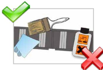
Le nettoyage des prismes et pièces optiques est recommandé au moins une fois par an ou plus fréquemment selon les conditions environnementales.
