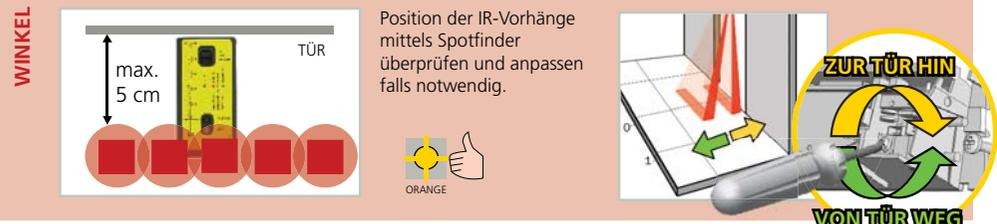
**TIP:** Eine INITIALISIERUNG MIT TÜRBEBEWEGUNG zur Überprüfung der Verkabelung, Position der IR-Vorhänge und korrekten Funktion des Sensors starten. Es wird empfohlen, optische Teile mindestens einmal pro Jahr zu reinigen, oder öfter falls Umgebungsbedingungen dies erfordern.
