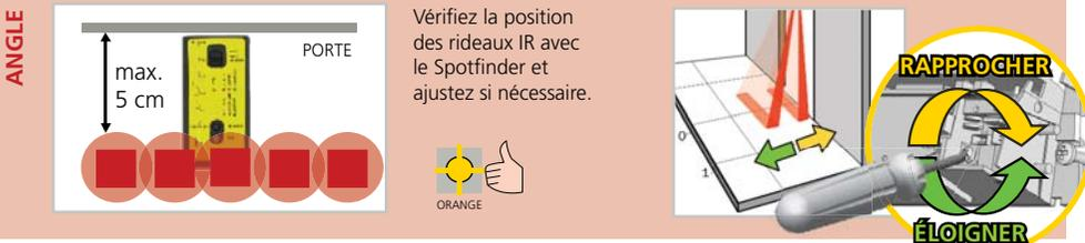
**CONSEIL:** Lancez un **SET-UP ASSISTÉ** pour vérifier le câblage, la position des rideaux et le fonctionnement correct du détecteur. Le nettoyage des pièces optiques est recommandé au moins une fois par an ou plus fréquemment selon les conditions environnementales.
