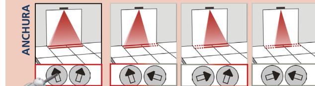
Una parte del campo puede ser tapada para reducir el campo de detección. La posición de la flecha determina la anchura del campo.
