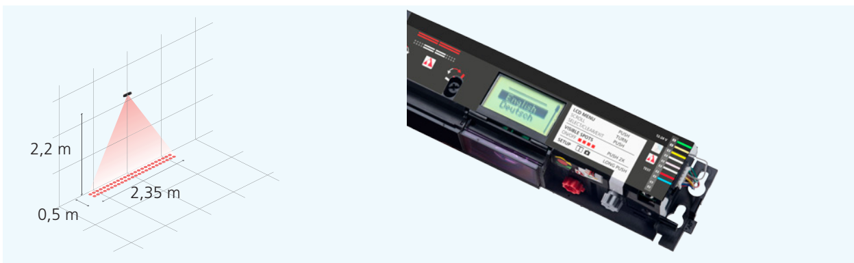
Infrarot Detektionsfeldgröße nach EN 16005: 2,35 m @ 2,2 m (Bei Immunitätswerten 2 und 3)* 2,45 m @ 2,2 m (Bei Immunitätswert 1)*
