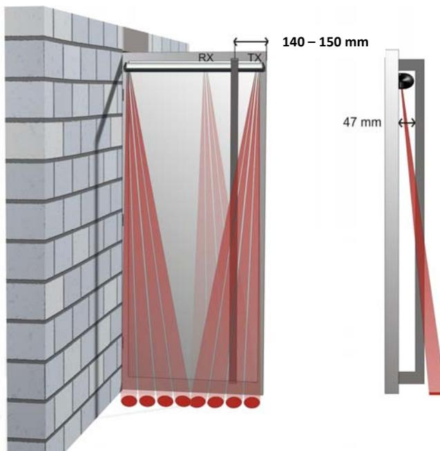
1. Installieren Sie den 4SAFE hinter den Handlauf, so dass der Handlauf sich zwischen dem TX (Sender) und RX (Empfänger) befindet (Beide Linsenpaare müssen freie Sicht haben).
