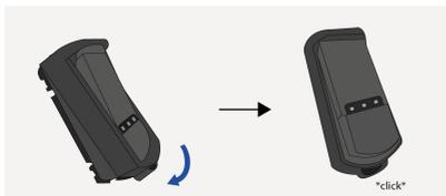
Remettez le capot de protection. Si nécessaire, utilisez la vis pour fixer fermement le capot.
