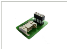
Retrofit Interface: Platine für Umrüstungen
