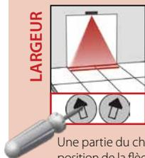
Une partie du champ de détection peut être masquée afin de le réduire. La position de la flèche détermine la largeur du champ IRA.
