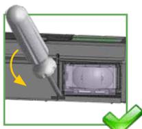
Pour un nettoyage complet, ôtez les deux fenêtres en insérant un tournevis dans les encoches situées entre les deux fenêtres.
