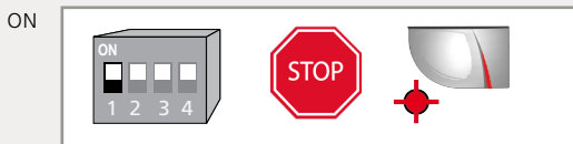
RELÉ 1: Señal de PARADA en el lado de apertura de la puerta.
