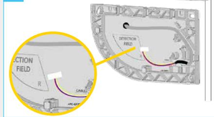
Führen Sie das Kabel durch die Bohrung. Legen Sie das Kabel in die Aussparung auf der Montageplatte und stellen Sie sicher, dass es fest sitzt.
