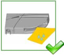
Das Laserfenster mit Druckluft reinigen. Wenn nötig, nur mit einem weichen, sauberen und feuchten Mikrofasertuch abwischen.
