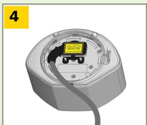
Apriete il coperchio della protezione, collegate il connettore ed inserite il cavo nel passaggio. Chiudete il coperchio di protezione e fissatelo saldamente.
