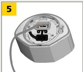
Die Schutzkappe öffnen, den Stecker anschließen und das Kabel in den Schlitz drücken.
