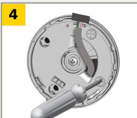
Den Montagesockel positionieren und die 4 Schrauben gut festdrehen um Vibrationen zu vermeiden.
