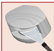
Direktes Bestrahlen mit Hochdruckreiniger ist zu vermeiden.
