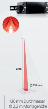
Der **RS-1** wurde entwickelt, um eine Zuginnentür zu öffnen oder sie offen zu halten, solange sich eine Person im direkten Türbereich befindet. Dies dient dem Komfort und der Sicherheit der Fahrgäste. Das Gerät wurde zur Erfassung in eingeschränkten Bereichen entwickelt und hat bei einer Montagehöhe von 2,2 Metern einen Lichtspottdurchmesser von nur 13 cm.
