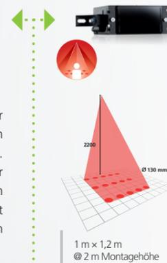
Der **RS-15** ist ein Sensor mit kombinierter Funktion für Innentüren: er erlaubt es Türen zu öffnen und offen zu halten solange noch eine Präsenz im Türrahmen erfasst wird. Dies dient dem Komfort und der Sicherheit der Fahrgäste. Hochflexibler Erfassungsbereich dank einer Matrix aus 3 x 5 konfigurierbaren Lichtspots.
