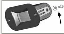
Bei der Montage eines FCA mit einem Fly, darauf achten die Scheiben einzufügen bevor sie die Schrauben befestigen.
