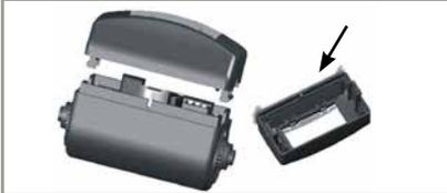
Beim Einfügen der Deckelhalterung in den Sockel achten Sie bitte auf den Positionierungsstift. Drücken Sie leicht auf die beiden Enden des Deckels.
