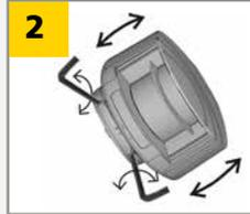
Ajustez l'angle d'inclinaison du détecteur avec une clé Allen.
