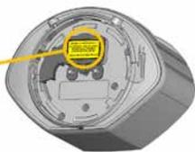
Il rilevatore contiene diodi laser infrarossi e visibili.
