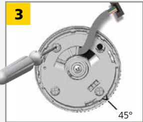
Installare il supporto di montaggio e fissare correttamente le 4 viti per evitare delle possibili vibrazioni.
