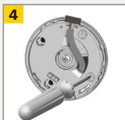
Installez le support de montage et fixez fermement les 4 vis pour éviter toute vibration.
