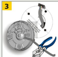
Passez le câble de min. 8 à 10 cm à travers l'ouverture. S'il n'y a pas de trou pour passer le câble, utilisez les conduits pour câble à l'arrière du support.
