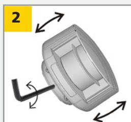
Ajustez l'angle d'inclinaison du détecteur avec une clé Allen.
