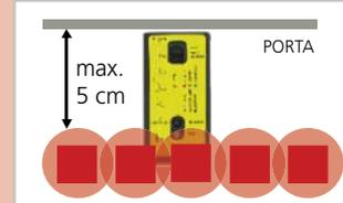
Verificate la posizione delle tende infrarosso con lo Spotfinder e regolate se necessario.
