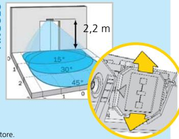
La larghezza della zona di rilevazione del radar dipende dall'altezza di montaggio del rilevatore.
