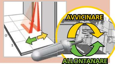
**CONSIGLIO:** Lanciate un **SETUP ASSISTITO** per verificare il cablaggio, la posizione delle tende ed il corretto funzionamento del rilevatore. Si consiglia di pulire le parti ottiche almeno una volta all'anno o con maggiore frequenza, se le condizioni ambientali lo richiedono.
