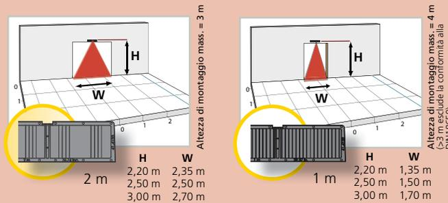
La larghezza del campo di rilevamento indicata è conforme alle condizioni definite nella DIN 18650 e include la dimensione del test-body CA.
