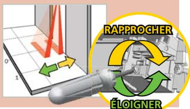
**CONSEIL:** Lancez un SET-UP ASSISTÉ pour vérifier le câblage, la position des rideaux et le fonctionnement correct du détecteur. Le nettoyage des pièces optiques est recommandé au moins une fois par an ou plus fréquemment selon les conditions environnementales.
