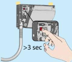
Der Service Modus deaktiviert die Absicherungserfassung des Sensors während 15 Minuten und kann während der Installation, dem mechanischen Einlernen des Antriebes oder bei Wartungsarbeiten nützlich sein.
