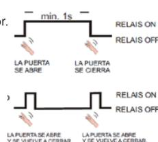
Asegúrese que el modo de salida esté en modo PULSE (P) para las aplicaciones de las puertas automáticas.
