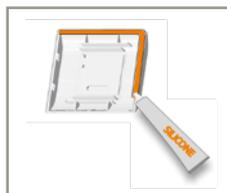
Para aumentar la resistencia a infiltraciones del agua, coloque una junta de silicona en la cara delantera.
