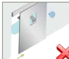
No coloque el detector en el campo de apertura de la puerta.
