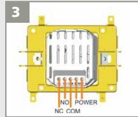
Connectez les brins au bornier à vis. Après la connexion, la LED clignote.
