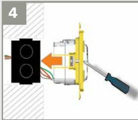
Insérez le boîtier dans la boîte d'encastrement et serrez les vis pour bien fixer le détecteur.
