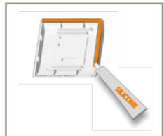
Pour augmenter la résistance aux infiltrations d'eau, vous pouvez placer un joint de silicone sur la face avant.
