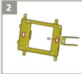
Si vous n'utilisez pas les pattes de fixation, dévissez-les et utilisez les vis livrées avec la boîte dans les trous ovales.
