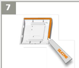
Pour augmenter la résistance aux infiltrations d'eau, vous pouvez placer un joint de silicone sur la face avant.
