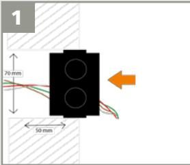
Faites un trou et insérez la boîte d'encastrement dans l'ouverture. Tirez les câbles à travers la boîte.
