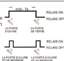
Assurez-vous que la sortie est en mode PULSE (P) pour les applications du type « portes automatiques ».
