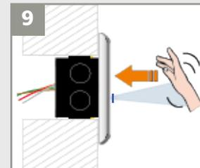
Vérifiez que le signal LED soit visible et testez le bon fonctionnement du détecteur.
