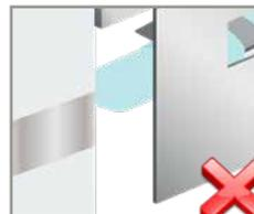
Ne placez pas le détecteur derrière des plaques métalliques.
