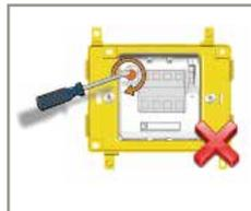
Ne forcez pas la vis lors de l'ajustement de la taille du champ de détection.
