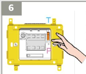
**MODE TOGGLE (BISTABLE) (T)**: recommandé pour des applications du type «interrupteur». Dans le mode bistable une détection active le relais et une seconde détection le désactive. Dans les application de portes, la porte reste ouverte après la première activation.
