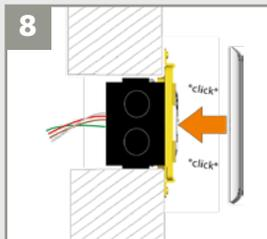
Clipsez la face avant sur la griffe de fixation. Vérifiez que la zone de la LED se trouve en bas pour éviter d'endommager la face avant.
