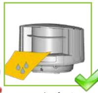
Nettoyez les fenêtres laser avec de l'air comprimé ou si nécessaire avec un chiffon microfibre propre et humide.
