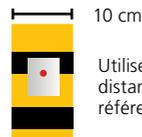
Utilisez l'autocollant réfléchissant si la distance entre le détecteur et le point de référence est supérieure à 5 m.
