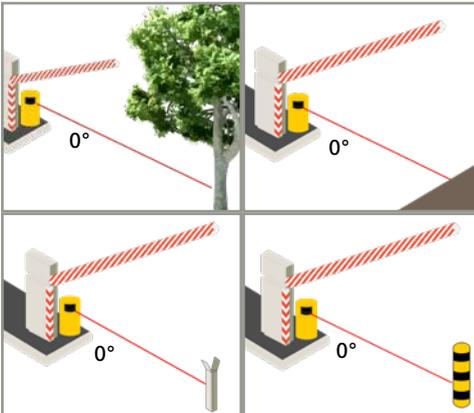
Le détecteur doit apprendre un point de référence lorsque le champ de sécurisation est la seule protection empêchant un contact entre le véhicule et la lisse.
