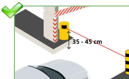
Installez le détecteur à une hauteur de 35 à 45 cm. Si la barrière n'est réservée qu'à des camions, la hauteur de montage peut être augmentée.
