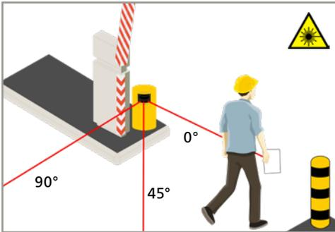
La position du détecteur et du champ de détection est essentielle pour un bon fonctionnement de la barrière.
