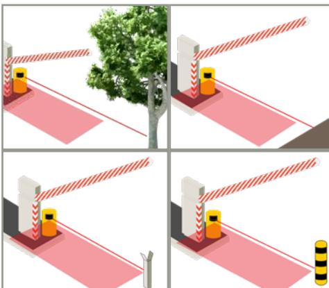
Si le champ de sécurisation est la seule protection empêchant un contact avec la lisse, le champ de sécurisation du détecteur doit se trouver en dessous de la lisse.
