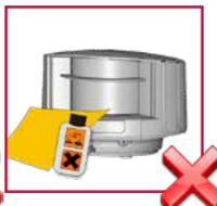
N'utilisez pas de détergent agressif ou abrasif pour nettoyer les fenêtres laser.
