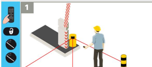
1 Activez les faisceaux laser visibles par télécommande.
