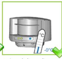
Laissez le laser alimenté en permanence en cas d'utilisation dans des environnements où la température peut descendre en dessous de 0°C.
