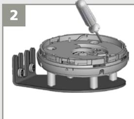
Installez le support de montage et fixez fermement les 4 vis pour éviter toute vibration.
