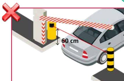
Si le faisceau de référence est placé trop haut ou trop bas, un contact entre le véhicule et la lisse ne peut pas être exclu.
