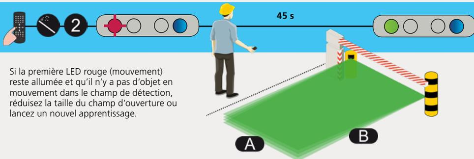
Si la première LED rouge (mouvement) reste allumée et qu'il n'y a pas d'objet en mouvement dans le champ de détection, réduisez la taille du champ d'ouverture ou lancez un nouvel apprentissage.
