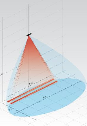
**Radar-Erfassungsfeld 4 m x 2 m, Infrarot-Erfassungsfeld 2,5 m x 0,6 m @ 3 m**
