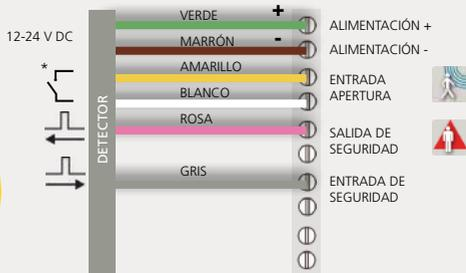
\* Estado de la salida con el sensor en funcionamiento.
