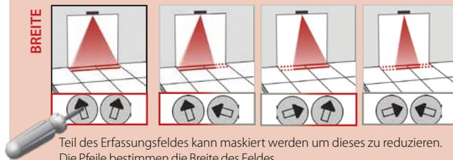
Teil des Erfassungsfeldes kann maskiert werden um dieses zu reduzieren. Die Pfeile bestimmen die Breite des Feldes.
