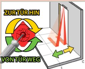
Falls notwendig, den Neigungswinkel des AIR-Vorhangs anpassen (von  $-7^\circ$  bis  $4^\circ$ ,  $0^\circ$  ab Werk).
