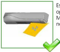
Es wird empfohlen die optischen Teile mindestens 1 Mal im Jahr oder mehr falls notwendig zu reinigen.
