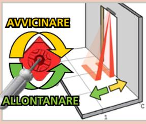
Se necessario, regolate l'angolo della tenda ad infrarossi (da -7° a 4°, 0° valore standard).
