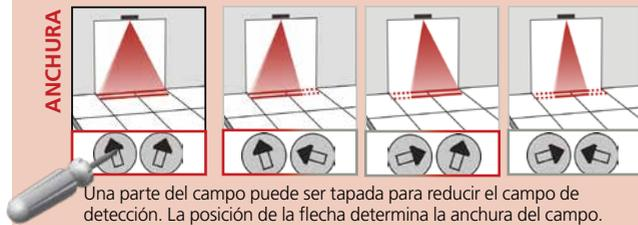
Una parte del campo puede ser tapada para reducir el campo de detección. La posición de la flecha determina la anchura del campo.
