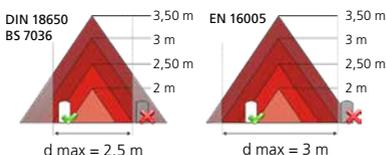
El tamaño de los campos de detección varían según la altura de montaje y los ajustes del detector. Toda la anchura de la puerta debe ser protegida.
