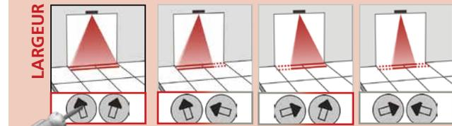
Une partie du champ de détection peut être masquée afin de le réduire. La position de la flèche détermine la largeur du champ IRA.
