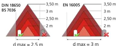
La taille du champ de détection dépend de la hauteur de montage et des réglages du détecteur. Toute la largeur de la porte doit être couverte.
