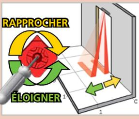
Si nécessaire, ajustez l'angle du rideau IRA (de  $-7^\circ$  à  $4^\circ$ ,  $0^\circ$  par défaut).
