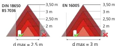
Le dimensioni della zona di rilevazione variano in funzione dell'altezza di montaggio e delle regolazioni del rilevatore. Si deve coprire la larghezza totale della porta.
