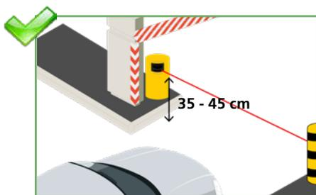
Installare il sensore ad un'altezza di montaggio di 35 - 45 cm. Se la barriera viene utilizzata esclusivamente da autocarri, l'altezza di montaggio può essere aumentata.
