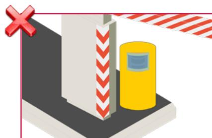
Evitare di coprire la superficie anteriore del rilevatore con vetro o plastica.
