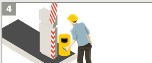
4 Per completare l'operazione, bloccare la posizione del rilevatore.
