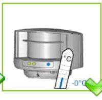
Lasciare il rilevatore alimentato in ambienti dove la temperatura può scendere sotto 0 °C.
