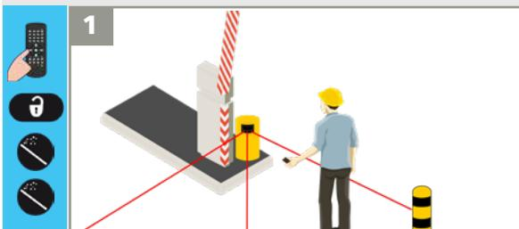
1 Attivare i raggi laser visibili tramite telecomando per posizionare correttamente il rilevatore.
