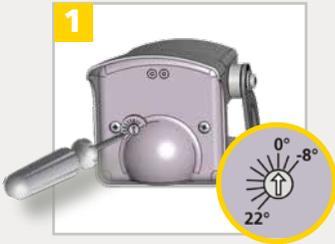
Al girar el tornillo del ángulo radar, el ángulo del campo radar se reduce o aumenta (de  $-8^\circ$  a  $+22^\circ$ ).
