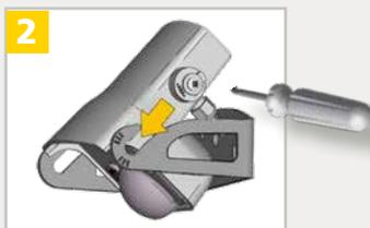
Posizionate il rilevatore nella staffa e fissate le viti saldamente.
