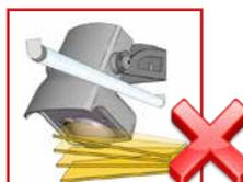
Evitate d'installare il rilevatore in prossimità di lampade al neon o ad oggetti in movimento.
