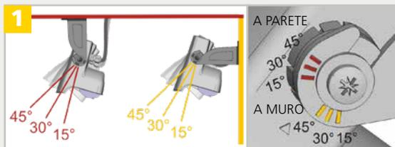
Regolate l'angolo del rilevatore per posizionare i campi di rilevazione.
