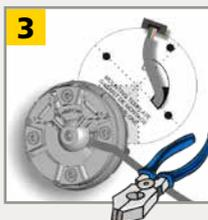
Passez le câble de min. 8 à 10 cm à travers l'ouverture. S'il n'y a pas de trou pour passer le câble, utilisez les conduits pour câble à l'arrière du support.
