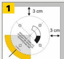
Utilisez le gabarit de montage pour positionner correctement le détecteur. La zone grise représente l'orientation de la zone de détection.
