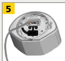
Ouvrez le couvercle de protection, branchez le connecteur et insérez le câble dans la fente.
