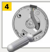
Installez le support de montage et fixez fermement les 4 vis pour éviter toute vibration.
