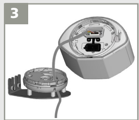
3 Aprire la copertura protettiva, inserire il connettore e posizionare il cavo nella fessura.
