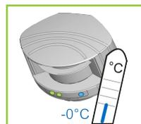
Laissez le laser alimenté en permanence en cas d'utilisation dans des environnements où la température peut descendre en dessous de 0°C.
