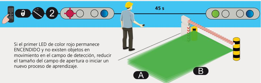
Si el primer LED de color rojo permanece ENCENDIDO y no existen objetos en movimiento en el campo de detección, reducir el tamaño del campo de apertura o iniciar un nuevo proceso de aprendizaje.
