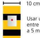
Usar un adhesivo reflectante si la distancia entre el sensor y la referencia es superior a 5 metros.
