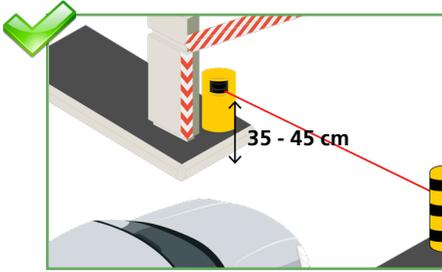
Instalar el sensor a una altura de montaje de 35 - 45 cm. Si la barrera se utiliza solo para camiones, la altura de montaje puede aumentarse.
