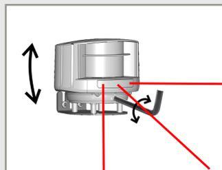
Ajustar el ángulo de inclinación del campo de detección con la llave hexagonal, si es necesario.
