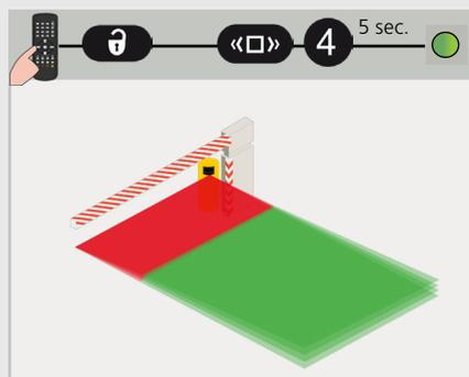
El sensor ajusta de forma predeterminada y automáticamente la anchura del campo de seguridad en función de la referencia.
