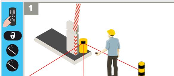
1 Activar los haces de láser visibles por control remoto para situar correctamente el sensor.
