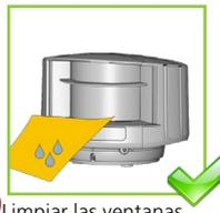
Limpiar las ventanas del láser con aire comprimido. Puede limpiarse únicamente con un paño de microfibras suave, limpio y húmedo.
