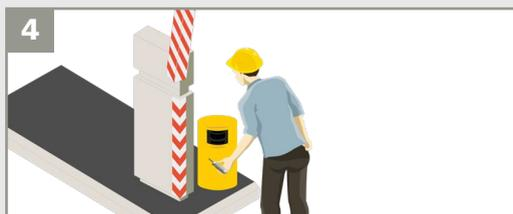
4 Para finalizar, bloquear la posición del sensor.
