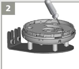
2 Colocar la montura y apretar los 4 tornillos con firmeza para evitar posibles vibraciones.
