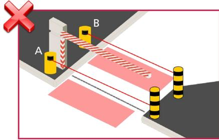
Cuando se utiliza el campo de seguridad, no situar el sensor antes de la barrera (A), ni a más de 40 cm. tras el mástil (B). La zona alrededor del mástil no es segura.
