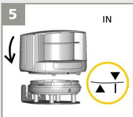
5 Colocar la carcasa en la montura.
