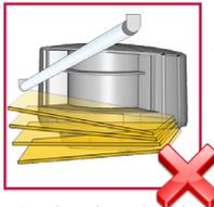
Evitar la colocación de objetos en movimiento y fuentes luminosas en el campo de detección.
