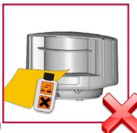
No utilizar productos agresivos para limpiar las ventanas del láser.
