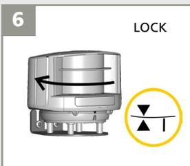
6 Girar el sensor hasta que los dos triángulos queden frente a frente.
