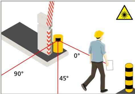
La posición del sensor y del campo de detección es muy importante para el correcto funcionamiento de la barrera.
