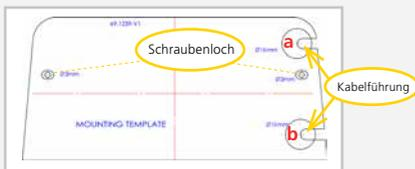
Platzieren Sie die Bohrschablone an die gewünschte Stelle. Bohren Sie die 2 Löcher für die Schrauben und das Loch für die Kabelführung.
