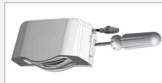
Entfernen Sie die Abdeckung mit einem Schraubendreher.
