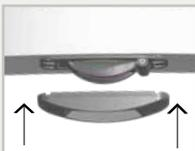
Stecken Sie die Frontblende auf, um die Montage abzuschließen.
