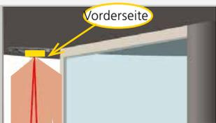
Stellen Sie sicher, dass die Vorderseite des Sensors (mit dem gelben Aufkleber) zur Drehachse der Tür zeigt.
