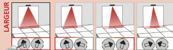
Une partie du champ de détection peut être masquée afin de le réduire. La position de la flèche détermine la largeur du champ IRA.
