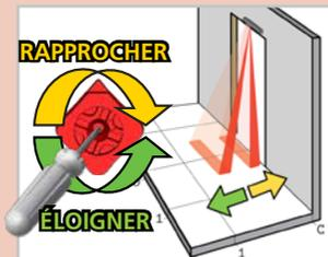
Si nécessaire, ajustez l'angle du rideau IRA (de  $-7^\circ$  à  $4^\circ$ ,  $0^\circ$  par défaut).
