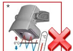
\* Evite la exposición del detector a cambios de temperatura extremos y repentinos.
