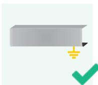
La base metallica sulla quale è montato il rilevatore deve essere collegata correttamente a terra.
