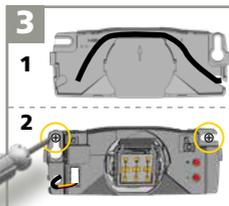
Per prima cosa, posizionare il cavo in base al foro nella parete. Per evitare di schiacciarlo, è possibile utilizzare il percorso del cavo dedicato. Quindi, fissare saldamente il sensore.
