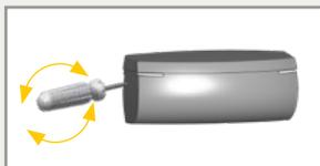
Inserire il cacciavite nella tacca a sinistra o destra del sensore e ruotarlo per rimuovere il coperchio.
